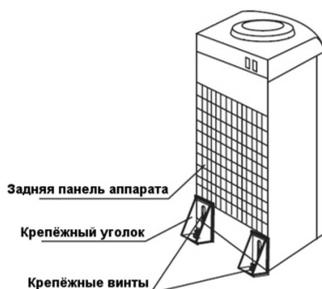
2. На задней панели аппарата в нижнем правом и левом углу извлеките крепёжные винты с помощью отвертки. Затем приложите крепёжные уголки и закрепите их винтом на аппарате, как показано на рисунке 3 (1-3).
