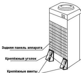
2. На задней панели аппарата в нижнем правом и левом углу извлеките крепёжные винты с помощью отвертки. Затем приложите крепежные уголки и
