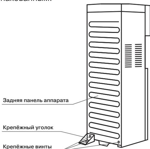
Во избежание падения аппарата, закрепите аппарат, следуя инструкциям на рис. 2 и 2а.
