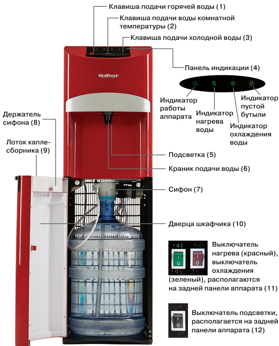
Рис. 1. Схема аппарата 45A Red
